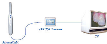
Podłączenie kamery przez wyjście „Composite Video” do TV
